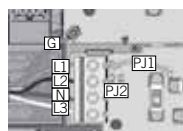
Triphasé « Y » (avec neutre)
